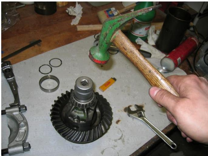
Das erhitze Lager müsste von alleine auf den Lagersitz gleiten und wird mit einer passenden Nuss auf Pressung geschlagen.
