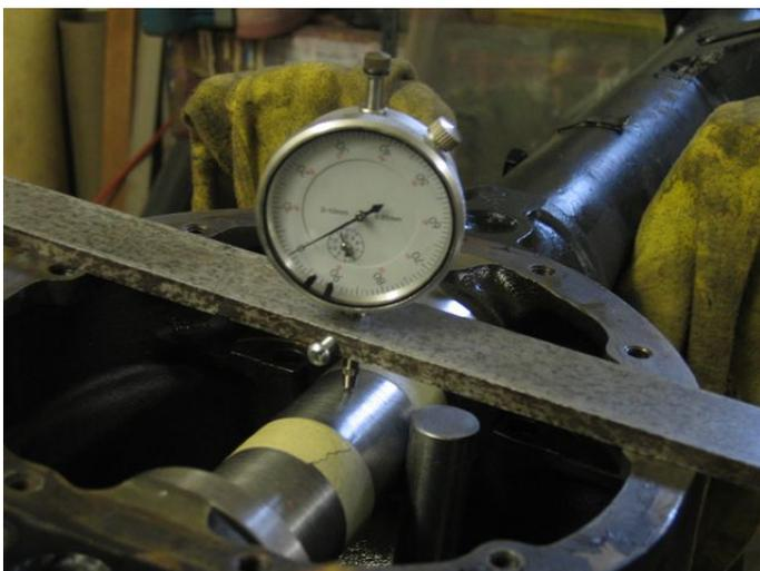
Nun kommt das Einstellwerkzeug ins Spiel. Die „Hantel“ wird in die penibel gereinigten Lagersitze des Ausgleichgetriebes gelegt und der 73mm hohe Kalieberdorn wird auf den Triebfling gestellt.
