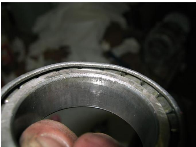
Dieses Lager weist am Laufring eine mechanische Beschädigung auf und sollte nicht mehr weiter verwendet werden.
