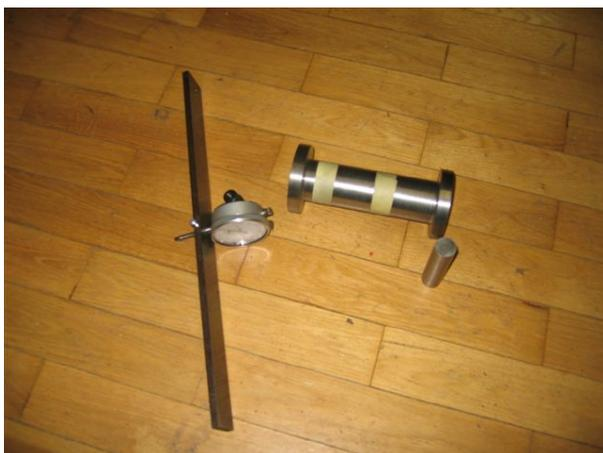
Zusätzlich zu diesen beiden Werkzeugen benötigt man noch eine Metallschiene in deren Mitte ein Loch gebohrt wird. In dieses kann die Messuhr gesteckt werden, welche mit einer Schraube fixiert wird! In den späteren Bildern ist das sehr schön zu erkennen!
