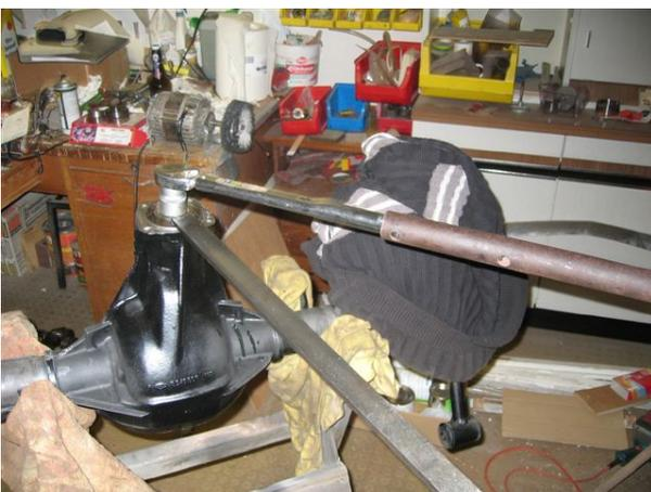
Mit dem Halteschlüssel wird die Triebblingswelle fixiert und die Einstellmutter angezogen, bis die Lager spielfrei sind. Dabei Triebbling immer wieder drehen, damit sich die Lager setzen können!
