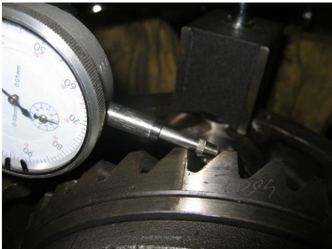
Um das Zahnflankenspiel zu messen wird die Messuhr tangential zum Tellerrad angebracht. Bei blockierten Triebbling wird das Ausgleichsgetriebe hin und her bewegt. Gemessen wird an mehreren Stellen, da das Spiel durch Seitenschlag des Tellerrades variieren kann! Anzustreben ist laut Anleitung ein Spiel von 0,12mm, was bei Gebrauchtteilen meiner Meinung fast nicht möglich ist! Viel wichtiger ist eh das Tragbild.
