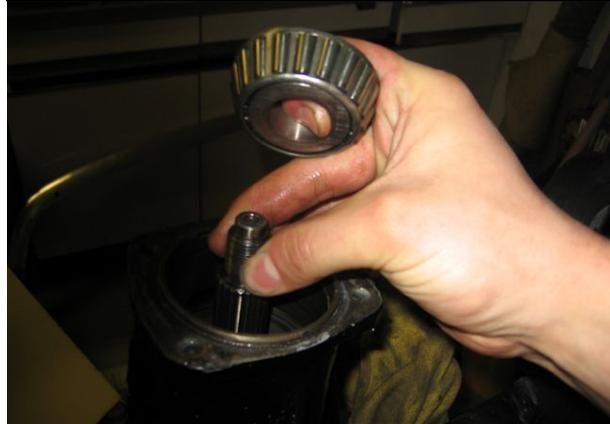
3. Ölablenkscheibe einsetzen
