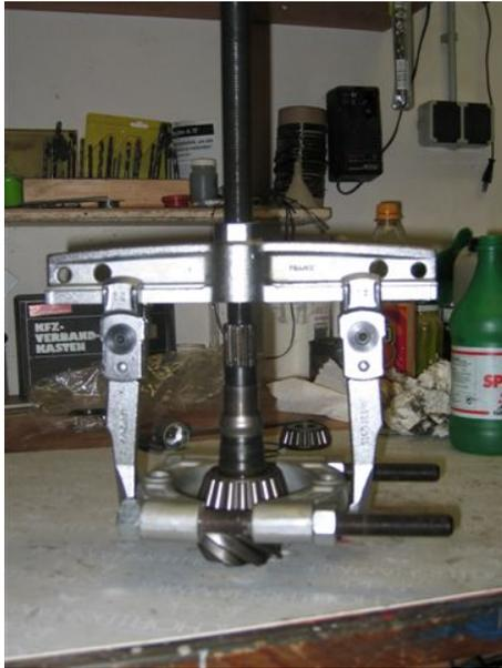
Inneres Lager wird mit Trenn- und Abziehvorrichtung vom Triebfling abgezogen.
