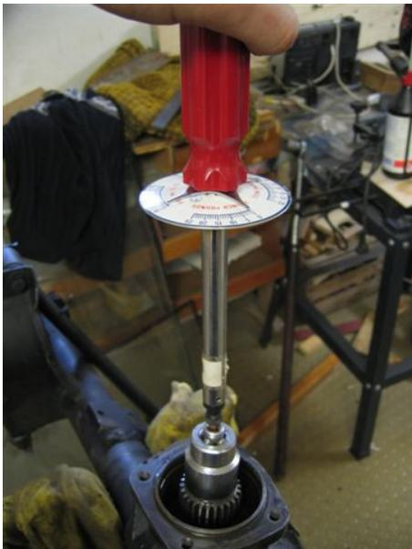
Nun wird mit einem Torsiometer die Vorspannung der Lager gemessen. **Wichtig:** Den Wert bei konstantem Drehen des Werkzeuges ablesen!
