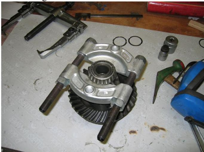
Trennvorrichtung am unteren Rand des Schulterlagers ansetzen und vorsichtig anziehen. Das Anziehen der Trennvorrichtung in kleinen Schritten erledigen und dabei immer wieder prüfen ob sich der Lagerkäfig frei drehen lässt! Wenn man falsch angesetzt hat kann es sein, dass er beschädigt wird!!!
