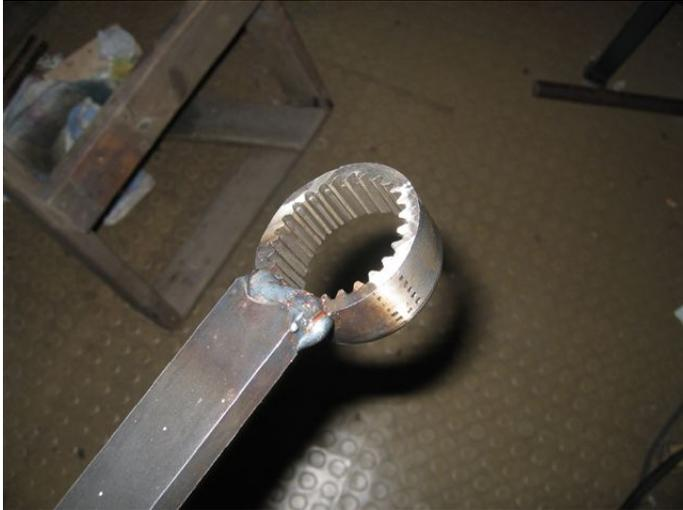
Selbstgebauter Halteschlüssel aus einer alten Antriebswelle.
