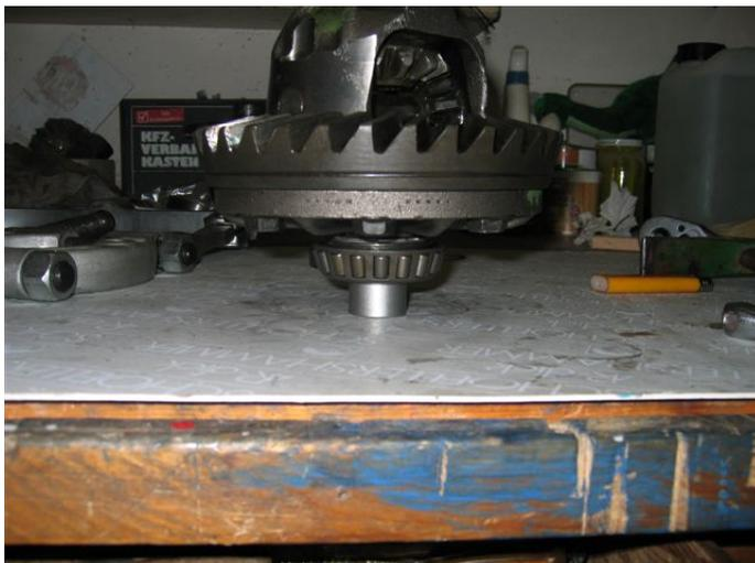
Beim aufschlagen des neuen Lagers das gesamte Ausgleichsgetriebe mit einer Nuss stützen um das untere Lager nicht zu zerstören!!!
