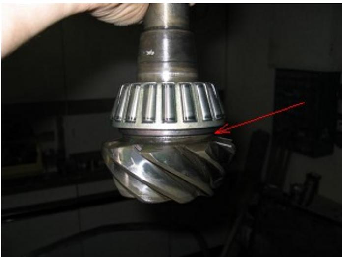
Das innere Lager des Triebblings, welchen man verwenden möchte (ggf. andere Übersetzung), muss nun abgezogen werden. Dazu wird die Trennvorrichtung am unteren Rand (roter Pfeil) des Lagers angesetzt! Die Spannschrauben zudrehen, bis sich das Lager etwas anhebt. Es ist also gelöst und kann problemlos abgezogen werden.
