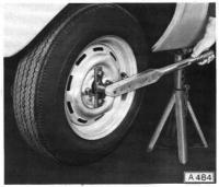
Der Sperrwert wird nach den gleichen Richtlinien, wie im Vorgang »Sperrausgleichgetriebe ausgebaut« beschrieben, ermittelt.
