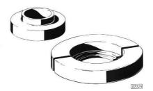
S-1206 Ausgleichgehäusekegellager-Druckstücke (2 Stück)
