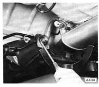
Dichtring vor dem Einschlagen mit Schutzfett, Katalog-Nr. 1948814, einfetten, dann mit Werkzeug KM-204 einschlagen.
