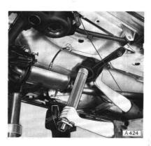
Hinterachsverlängerung, wie Bild A 425 zeigt, weiter nach vorn drehen und seitlich über Auspuffanlage (links) und Handbremsseil (rechts) abnehmen.
