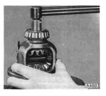
Spiralstift für Ausgleichachse bis Anschlag einschlagen.
