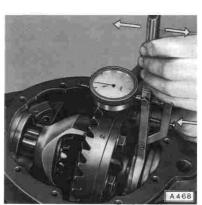
Abstand zwischen Ausgleichgetriebe und Achsgehäuse an den 4 gekennzeichneten Stellen messen und kleinsten Meßwert festhalten. Zur Kontrollmessung Tellerrad entgegen der vorherigen Drehrichtung mit einer Umdrehung auf die Stelle mit dem kleinsten Meßwert zurückdrehen.
