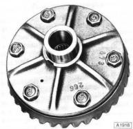
Tellerradschrauben (Tensilock-Schrauben) bei Fahrzeugen mit 16 S-, 19 S-, 19 E-Motoren in gezeigter Reihenfolge auf vorgeschriebenes Drehmoment festziehen. Stets neue Tensilock-Schrauben verwenden.
