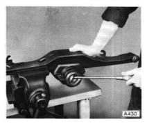
Gummilager für Hinterachsverlängerung am Bund aufsägen – kann nicht abgepreßt werden.
