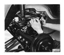
Vordere und hintere Buchse mit Dorn von S–1193 unter Presse aus Lenker herauspressen (A). Buchse mit angeführtem Dorn in der Reihenfolge a, b unter Presse eindrücken (B). Als Gleitmittel Testbenzin verwenden. Beim Einbau Schrauben am Federsitz und am Unterbau von außen nach innen einsetzen. Stets neue, selbstsichernde Muttern aufschrauben. Kunststoffhülse für Handbremsseilführung in Längslenker einsetzen. Befestigungsteile auf vorgeschriebenes Drehmoment festziehen.
