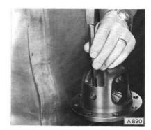
Tellerradschrauben (Sechskant-Schaftschrauben) bei Fahrzeugen mit 12 S-, 16 N-Motoren auf einer Länge von ca. 10 mm mit Dichtungsmasse, Katalog-Nr. 1505 101, bestreichen und in der gezeigten Reihenfolge auf vorgeschriebenes Drehmoment festziehen.
