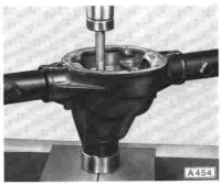
Kegelkäfig von Antriebskegelrad abpressen. Bei Fahrzeugen mit 12 S-, 16 N-Motoren: Werkzeug S-1205, 16 S-, 19 S-, 19 E-Motoren: Werkzeug SW-56
