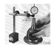
Dann auf beiden Seiten mit Meßuhr und Meßdorn SW-237 größten Abstand zwischen Achswellenkegelrad und Ausgleichgehäuse messen. Hierzu sind jeweils 2 Messungen durchzuführen: Einmal bei Zahnflankenspiel "O" (tiefste Stellung des Kegelrades) und zum anderen bei bis zum Anschlag hochgehobenem Kegelrad (höchste Stellung).
