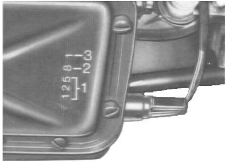
Das Getriebe im Rekord E1 Diesel mit Sportgetriebe ist übrigens verstärkt. Alle Commodore C erhielten ebenfalls dieses Getriebe.
